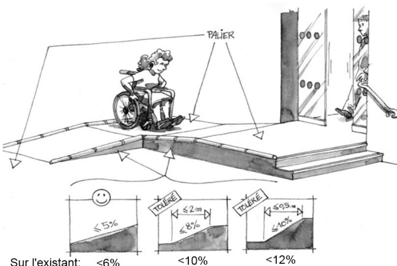
Les mains courantes sont recommandées au-delà de 4% (section ronde 4cm de diamètre recommandé)
