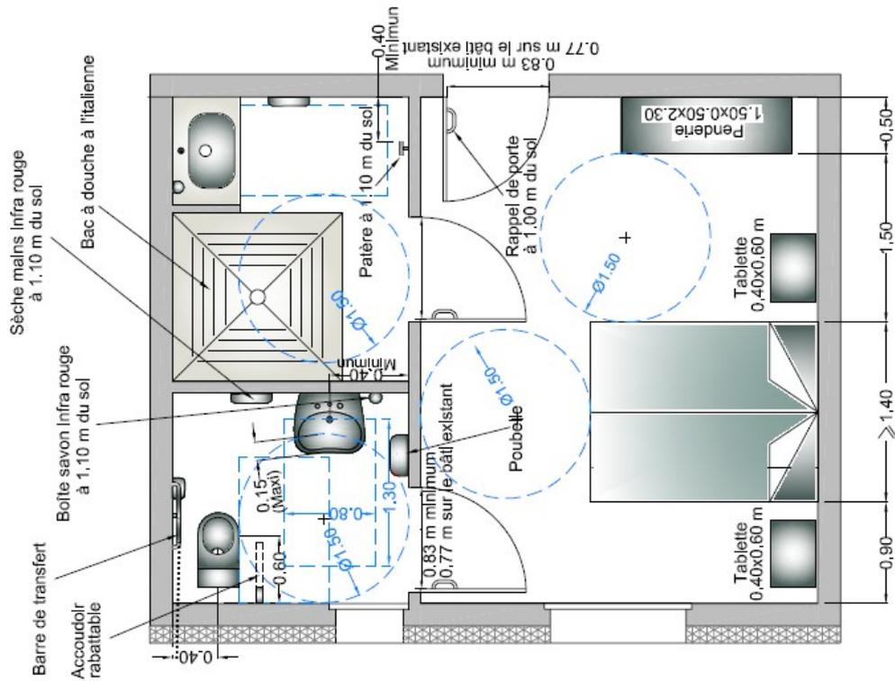
Prises électriques à hauteur 0,40 m du sol et 0,60 m d'un angle rentrant.
